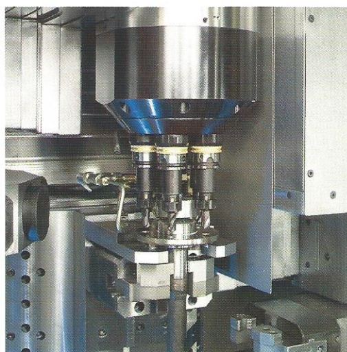
Foratura di una flangia con testa motorizzati a più fusi
