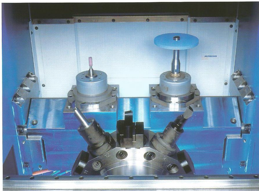
Zona di lavoro VSC 250 DS: Torretta a disco per 12 utensili di tornitura e due mandrini fissi di rettificazione (1 per la rettificazione del foro, 1 per la rettificazione del diametro esterno)
