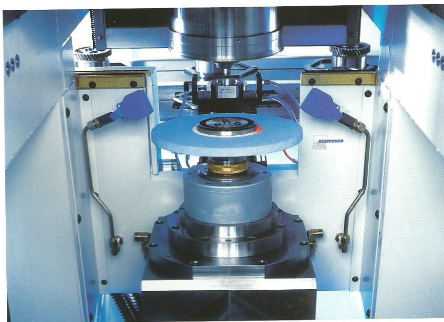
Blocco utensili con un mandrino di rettificazione per la finitura del cono del sincronizzatore di un ingranaggio
