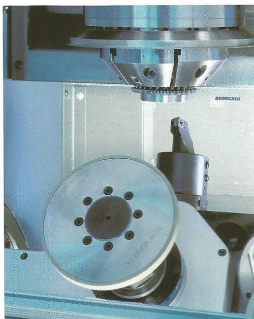
Tornitura temprata e rettificazione di finitura del cono di un sincronizzatore per cambio auto
