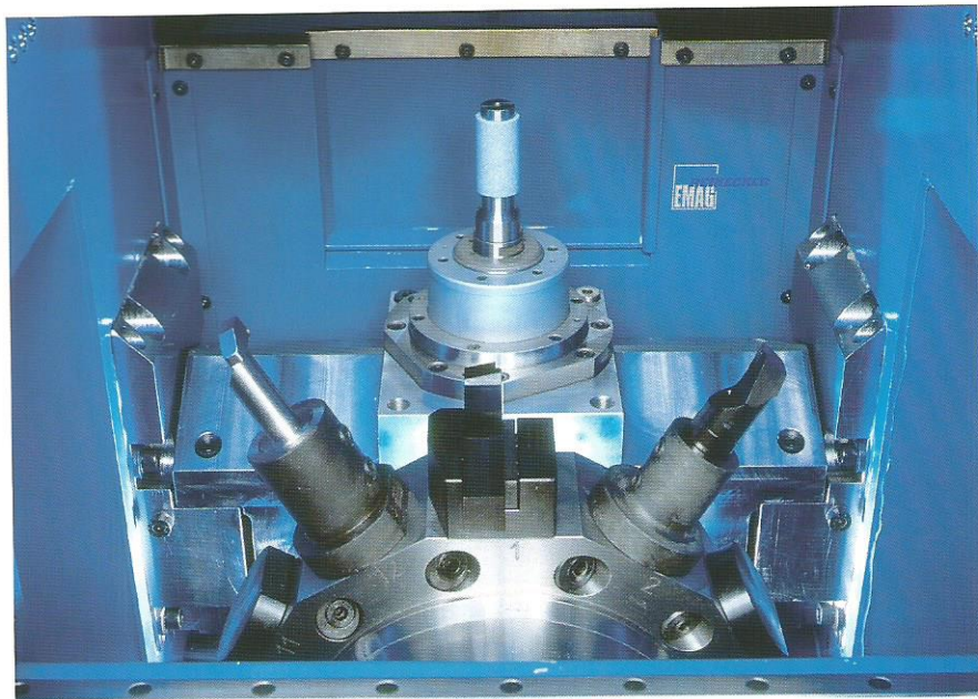
Zona di lavoro VSc 250 DS: Torretta a disco per 12 utensili di tornitura ed un mandrino fisso per la rettificazione di fori
